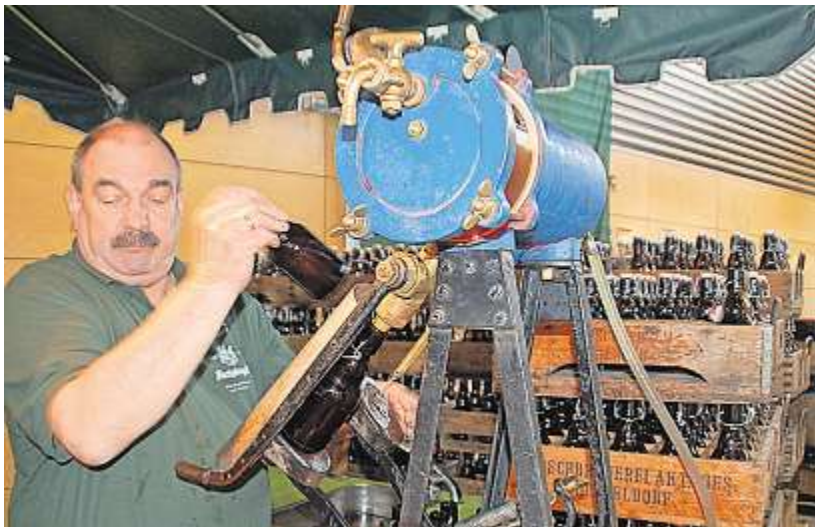
200 Flaschen pro Stunde schafft die Abfüllanlage aus dem Jahr 1910.
